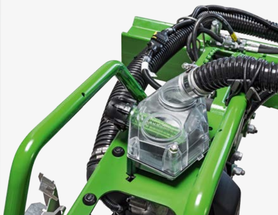
Распределительный элемент с небольшим запасным контейнером над каждым высевальным агрегатом
