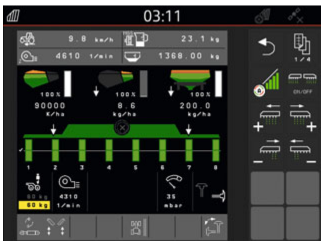
Интеграция распределителя микрогранулята в рабочее меню терминала
