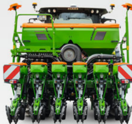
Presea 4500-2CC с вариативно телескопической рамой при минимальной ширине захвата
