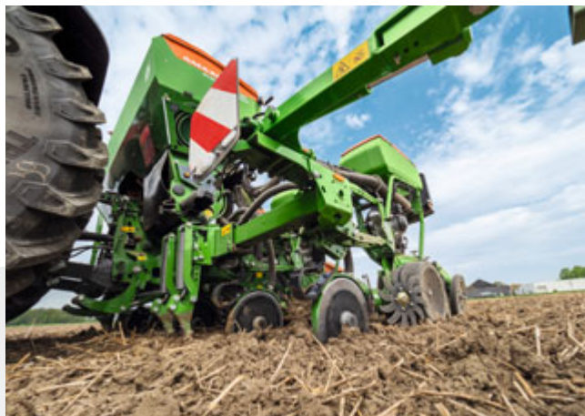
Пресеа со следорыхлителем следов трактора в работе
