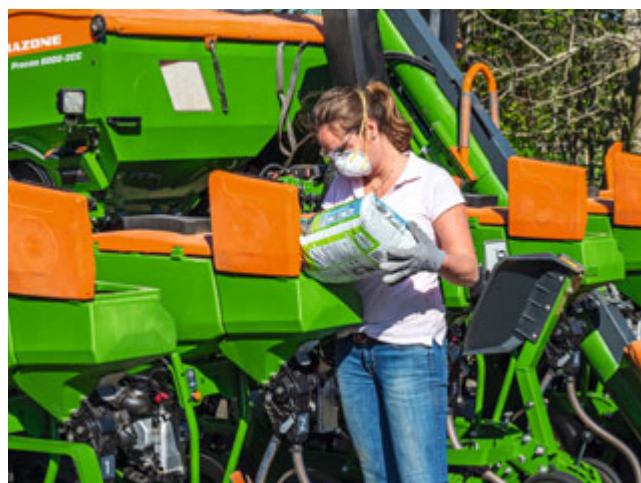
Простое заполнение бункера для микрогранулята
