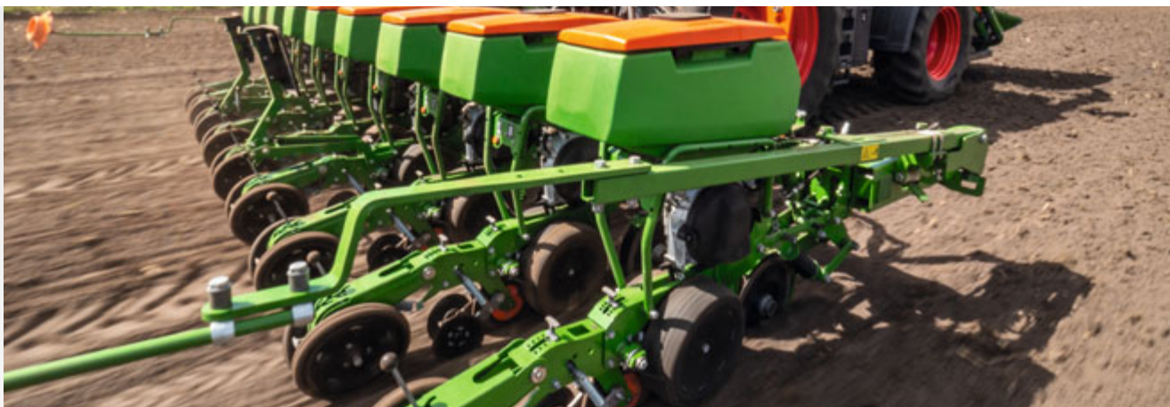
Семенные бункеры над дозирующими устройствами
