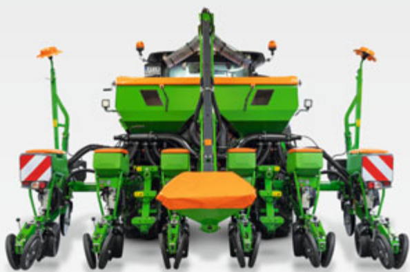
Presea 4500-2CC с телескопической рамой при полной ширине захвата
