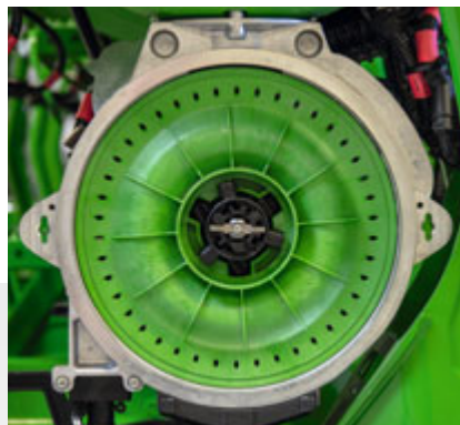
Используемый дозирующий диск в состоянии покоя
