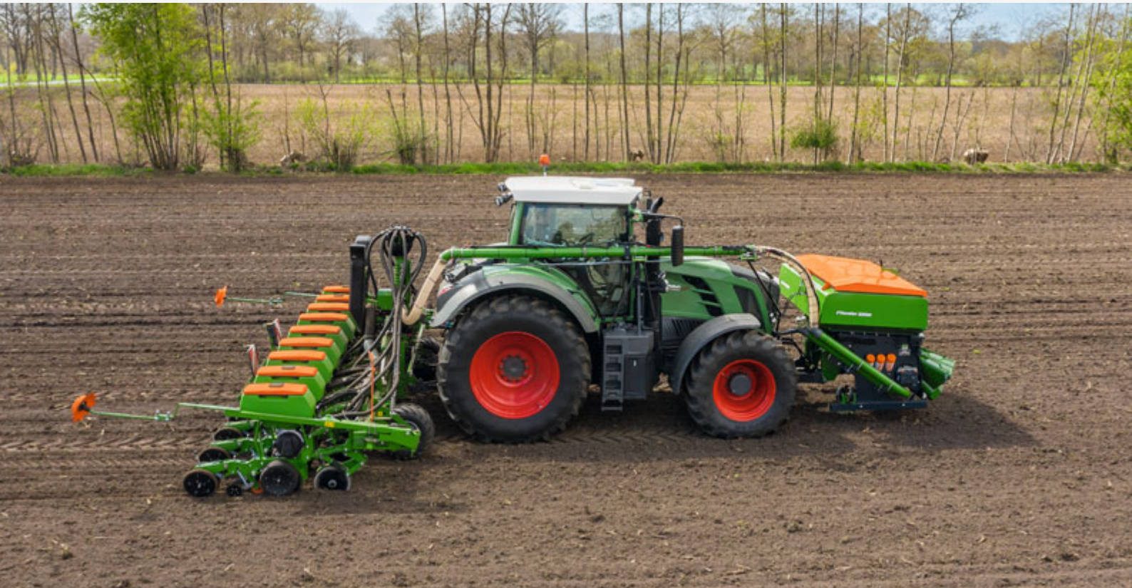
Фронтальный бункер FTender 2200 с сеялкой точного высева Precea 6000-2FCC
