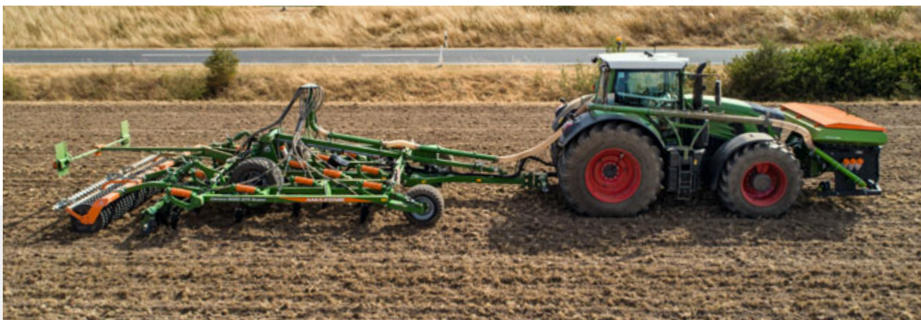
Фронтальный бункер FTender 1600 с прицепным культиватором Cenius-2TX
