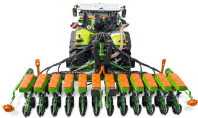
Пресеа 6000-2FCC с 12 рядами в разложенном состоянии
