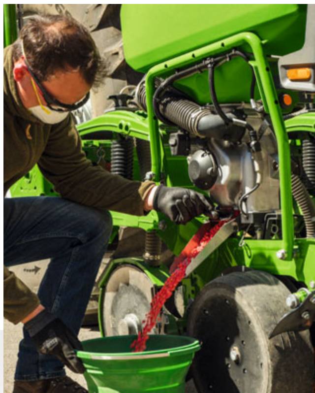
Удаление остатков происходит вручную, очень быстро, аккуратно и просто. И даже с обеих сторон.
