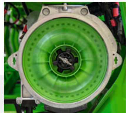
Дозирующий диск в действии (без крышки)
