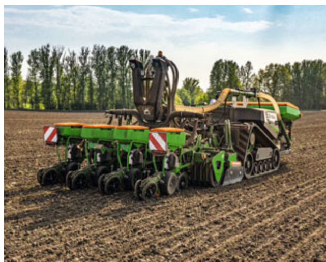
Пресеа 3000-AFCC с ротационным культиватором KG
