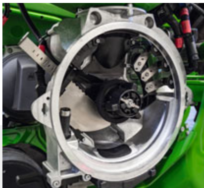
Вид дозирующего устройства без дозирующего диска
