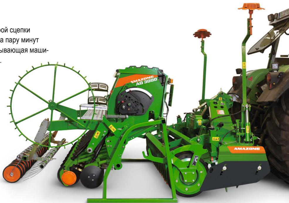
Три точки соединения с удобным доступом системы быстрой сцепки QuickLink способствуют безопасному и быстрому процессу соединения и разъединения без использования инструментов
