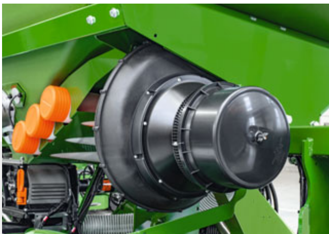
Опциональный циклонный пылеуловитель снижает степень запыленности
