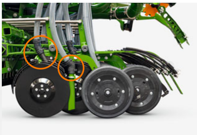
Сошник TwinTeC с дополнительным выходным отверстием
