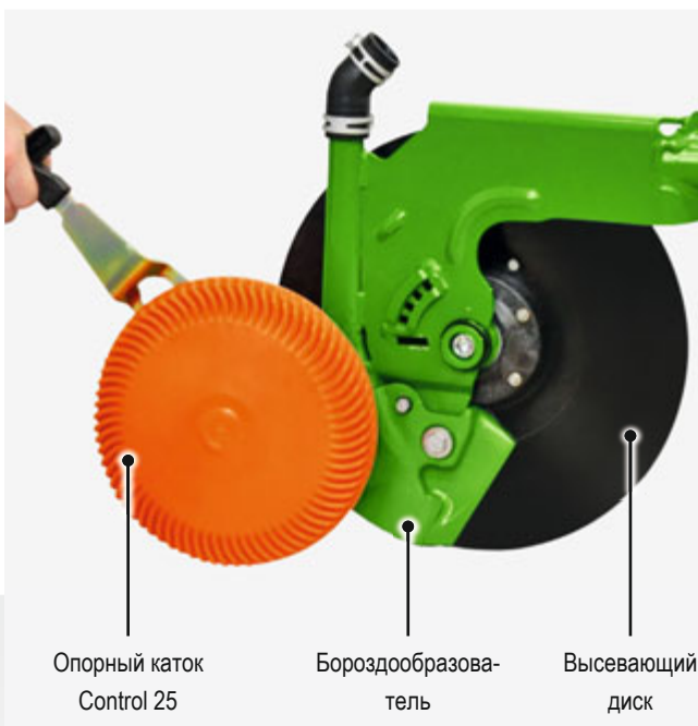
Сошник RoTeC pro (Ø 400 мм) с опорным катком Control 25 Открытые ламели на тыльной стороне обеспечивают идеальную самоочистку.
