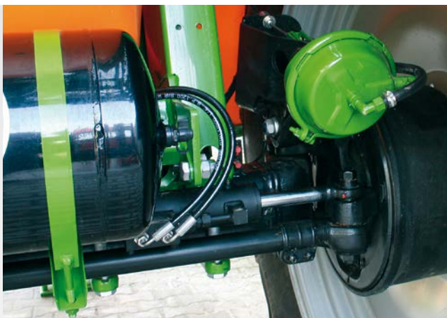
Руление с поворотными кулаками AutoTrail
