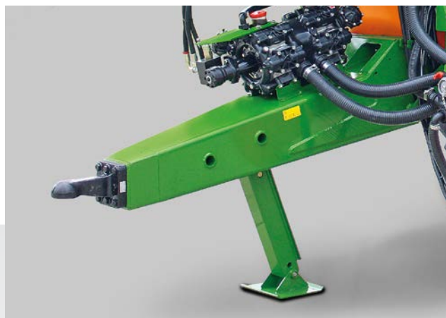
Дышло с нижним зацеплением с шаровой опорой К 80 и гидравлической стояночной опорой
