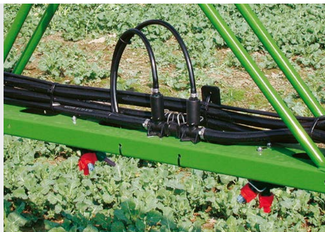
Система принудительной циркуляции (DUS)
