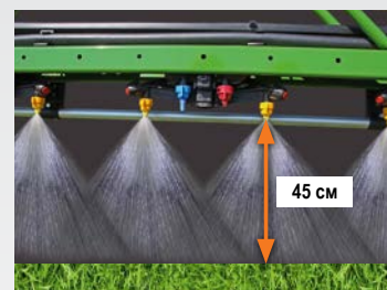
Форсунки 80°: Расстояние между форсунками 25 см
