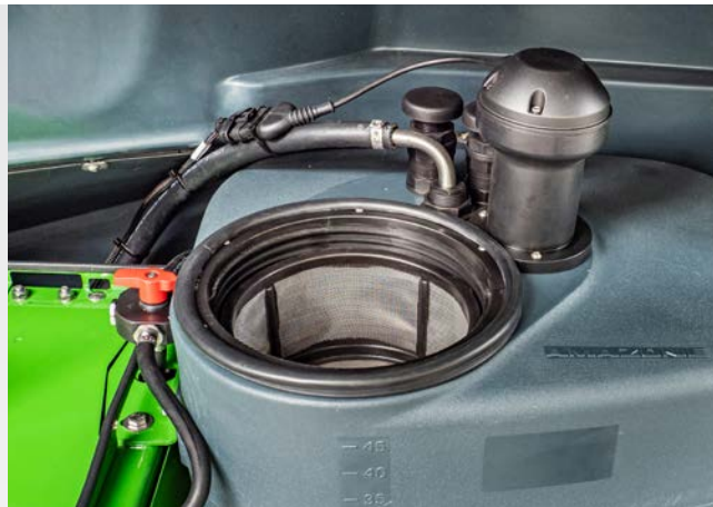
Бак DirectInject с интегрированным решетом для простого и безопасного заполнения
