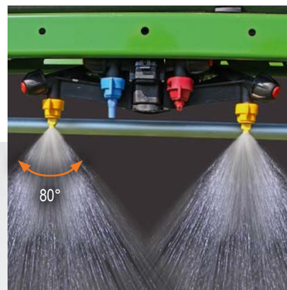
Электрическое пофорсуночное включение AmaSelect с 4-корпусным держателем и расстоянием между форсунками 50 см или 25 см
