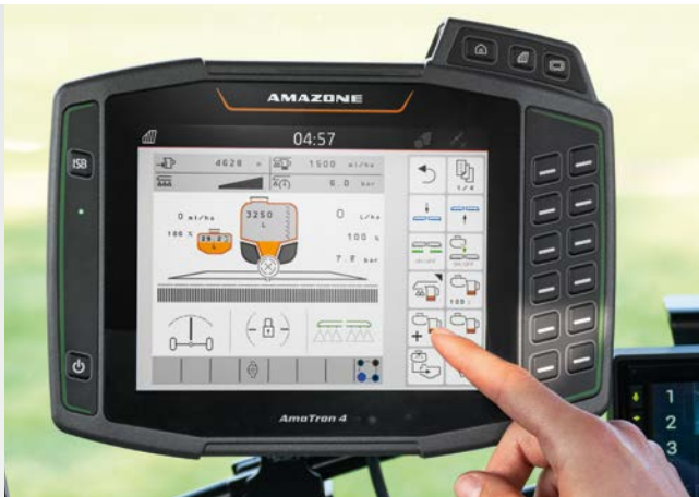
Активация DirectInject на терминале AmaTron 4
