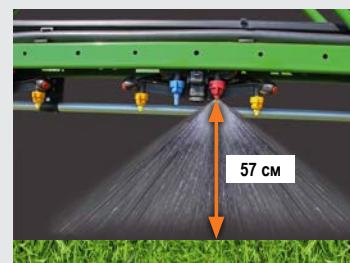
Форсунка 110°: Расстояние между форсунками 50 см
