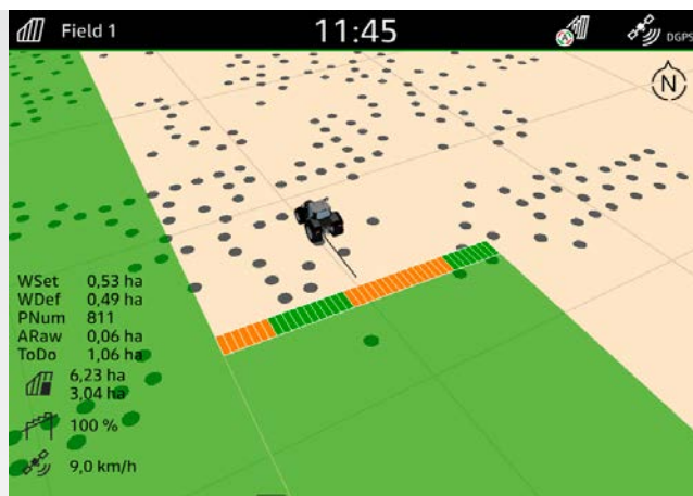
Изображение точечной обработки на AmaTron 4
