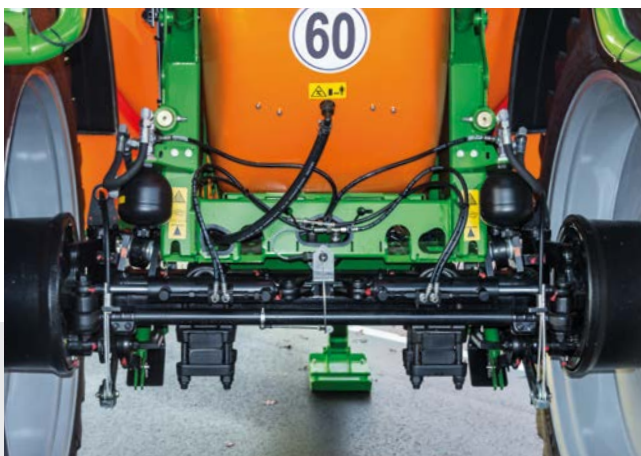
Гидропневматическая подвеска оси с рулением с поворотными кулаками AutoTrail для UX 4201и UX 5201
