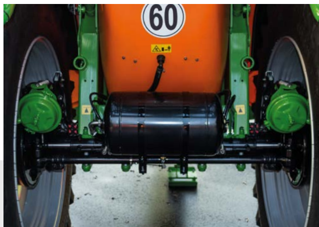
Руление с поворотными кулаками AutoTrail
