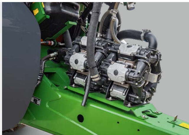
Система с двойным насосом UX 11201 Super реализует мощность всасывания до 900 л/мин
