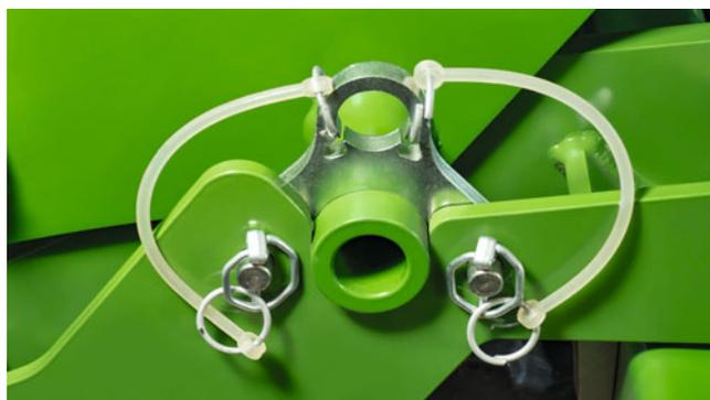
✔ Три точки соединения с удобным доступом системы быстрой сцепки QuickLink способствуют безопасному и быстрому процессу соединения и разъединения без использования инструментов.
