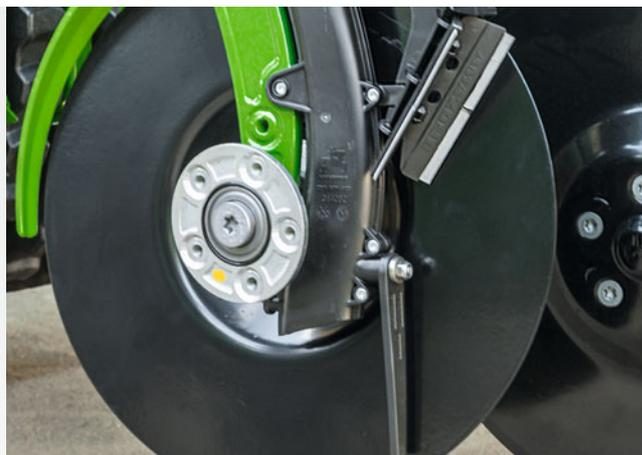
Твердосплавные внутренние чистики для вязких, глинистых почв обеспечивают беспрепятственный ход сошника
