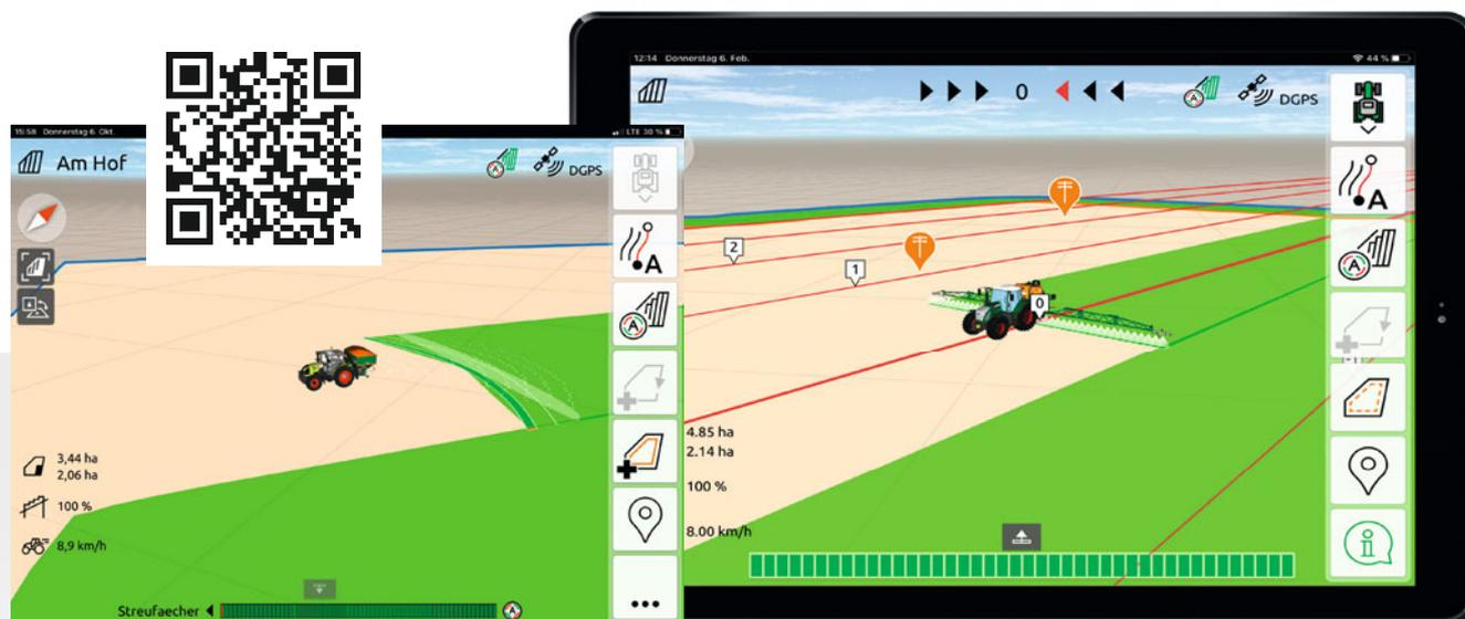
Альтернативный просмотр карт с AmaTron Twin – Наглядное изображение эксплуатируемой машины и ее секций, а также кнопки на правой стороне мобильного устройства.
