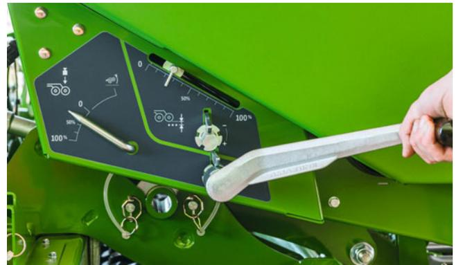
Централизованная бесступенчатая механическая регулировка давления на сошник со шкалой Cataya Super
