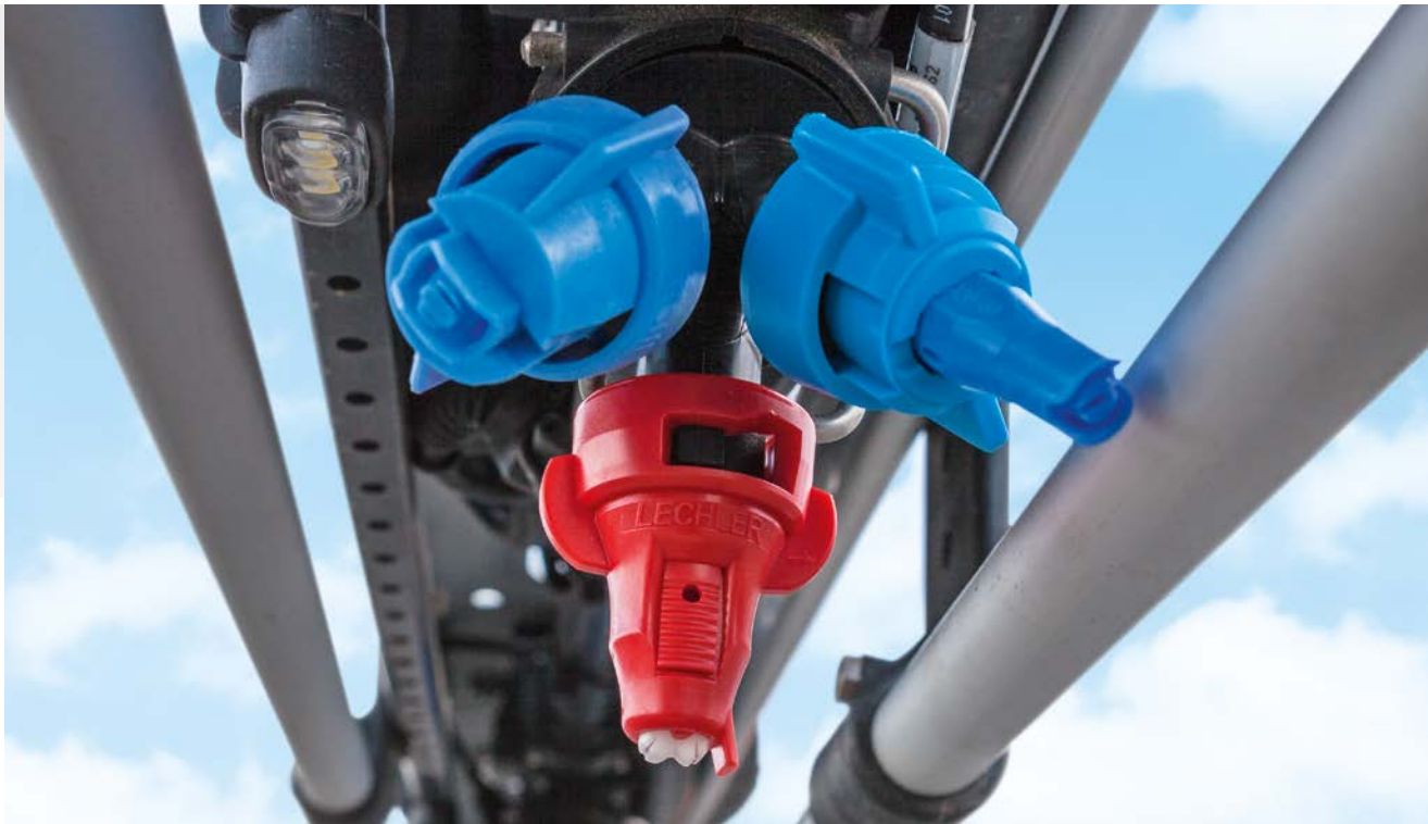
3-корпусный держатель форсунок AmaSwitch с LED-подсветкой
