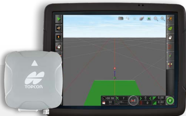
ISOBUS-терминал TopCon X35 с приемником AGS-2 для автоматического ведения по колее и посекционного включения
