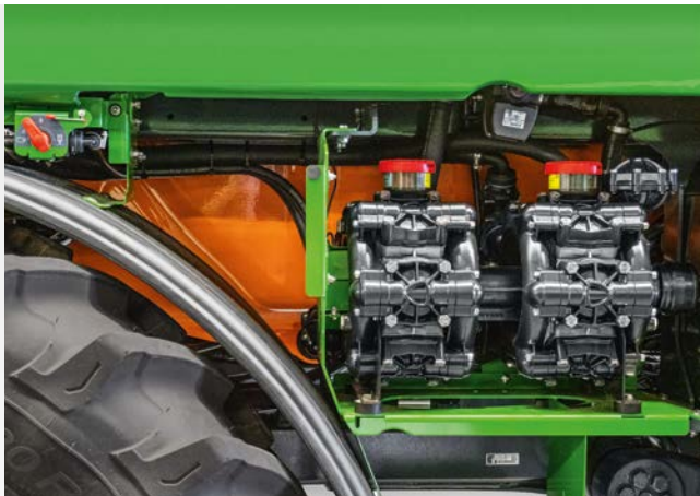
Насосное оборудование на правой стороне машины
