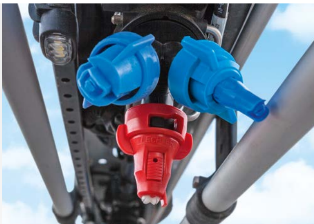
✔ Электрическое пофорсуночное включение AmaSwitch
