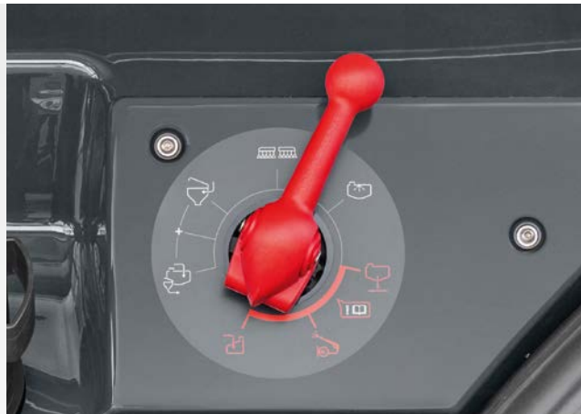
7-ходовой напорный вентиль собственной разработки
