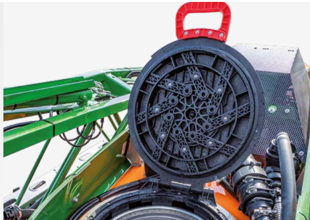
Герметичная куполообразная крышка бака
