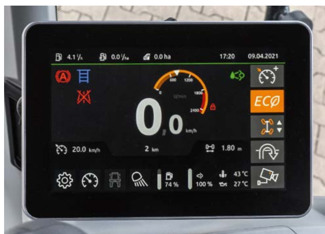
Терминал шасси AmaDrive 7.0
