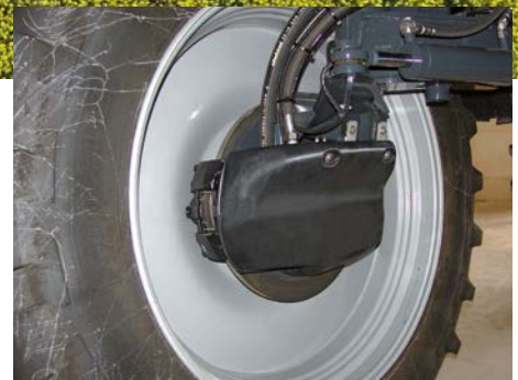
✔ Серийные щитки мотор-колес на Pantera 4504
