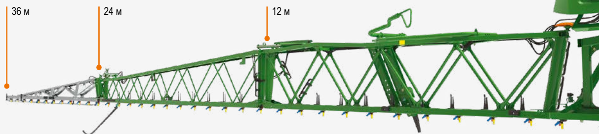
Штанга Super-L3 с шириной захвата 36 м, с уменьшением до 24 м и 12 м
