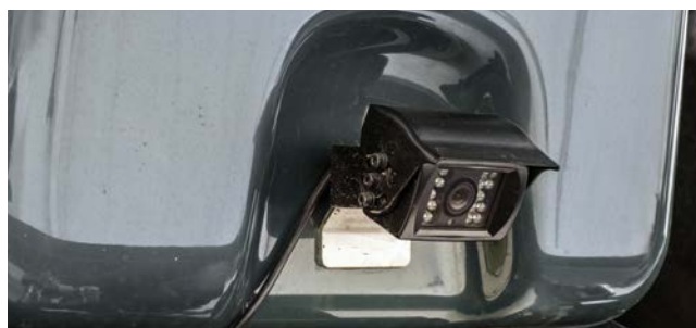
Камера заднего вида в задней части Pantera
