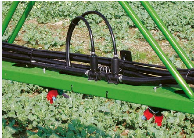
Система принудительной циркуляции (DUS)
