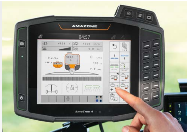
Активация DirectInject на терминале AmaTron 4
