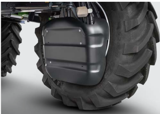
Щиток мотор-колеса на Pantera-H и Pantera-HW
