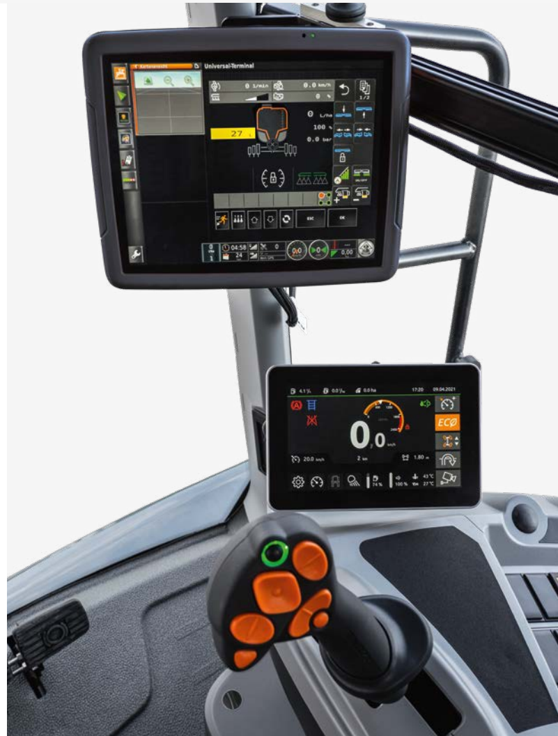
Решение с двумя терминалами: ISOBUS-терминал TopCon X35 и терминал шасси AmaDrive 7.0, а также многофункциональный джойстик AmaPilot+
