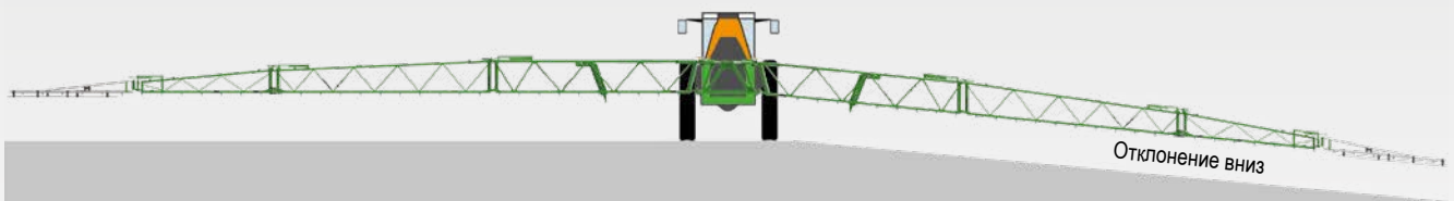
Отклонение вниз (через складывание Flex 2 в комбинации с ContourControl)
