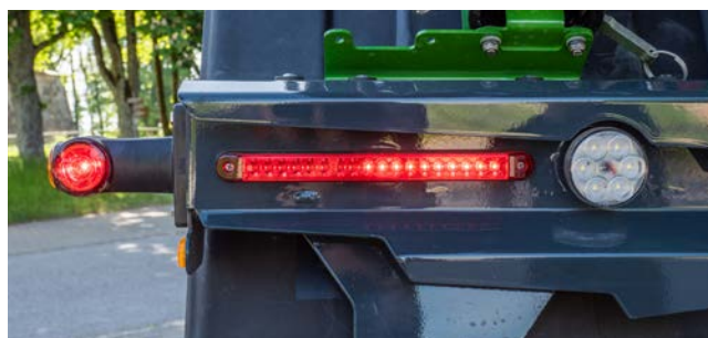
✔ Серийные светодиодные задние фонари
