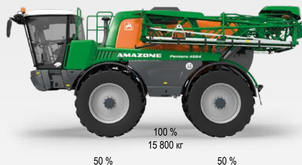
Распределение массы в заполненном и разложенном состоянии
