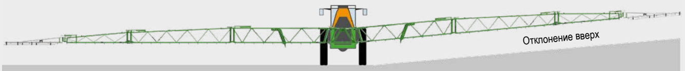
Отклонение вверх (через складывание Flex 2)
