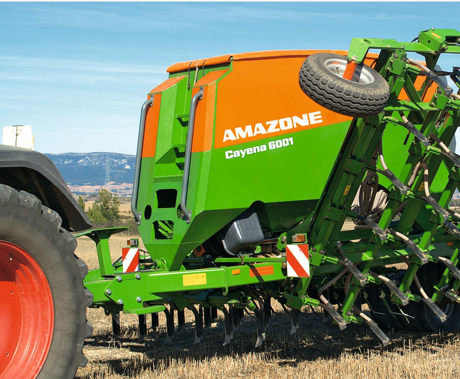
Прицепная сеялка с долотовидными сошниками Sauepa разработана для быстрого посева на тяжелых, сухих и каменистых почвах с предварительной обработкой почвы или без таковой.
