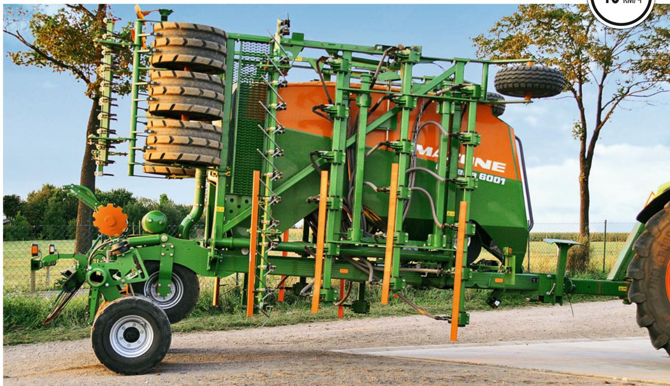
Дополнительные защитные накладки на сошниках повышают безопасность на дорогах
