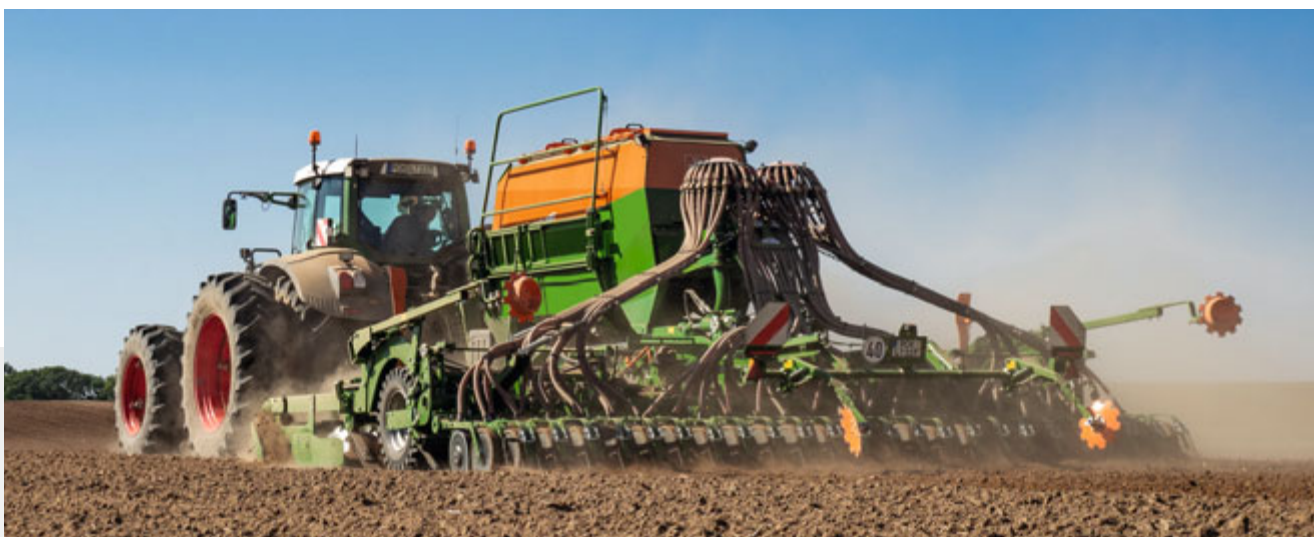
Применение ножевого катка для формирования мелкоструктурного семенного ложа при посеве пшеницы
