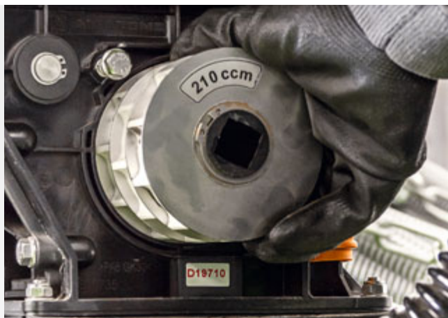
Дозирующие катушки для различных видов посевного материала
