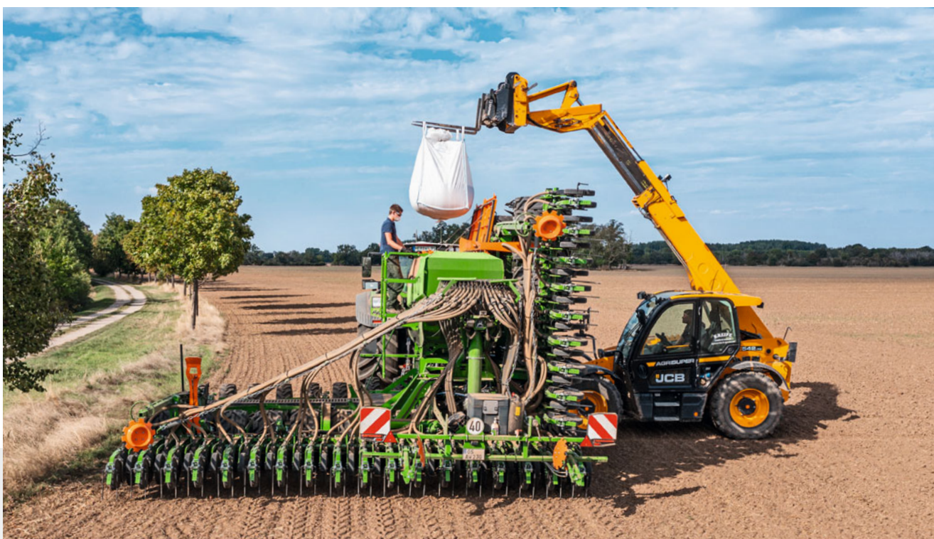
Одностороннее складывание при загрузке существенно уменьшает загрузочную ширину и позволяет проводить заполнение машины даже с помощью небольших телескопических погрузчиков
