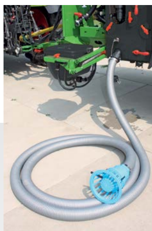
Заполнение через всасывающий шланг
