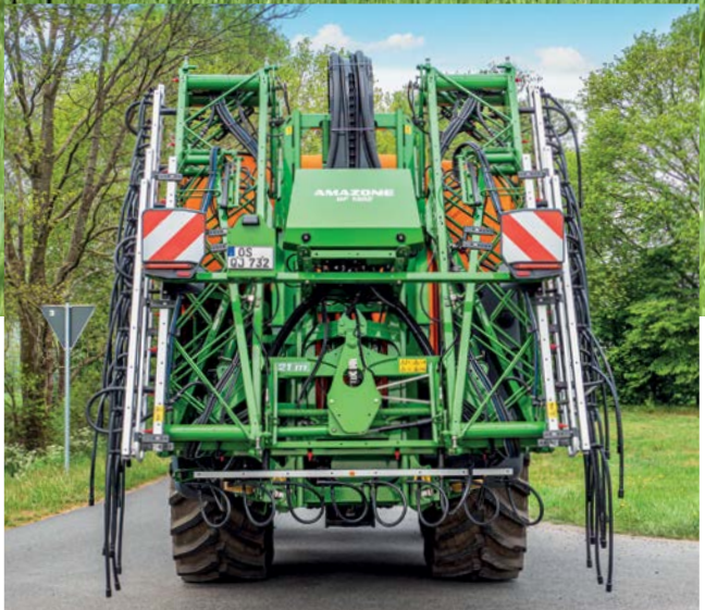
Шланги для жидких удобрений с шарнирным соединением
