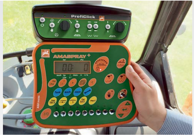
✓ Комфортная установка ProfiClick на AmaSpray+
