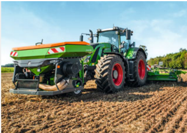
Фронтальный бункер FTender 1600 с объемом 1.600 л
