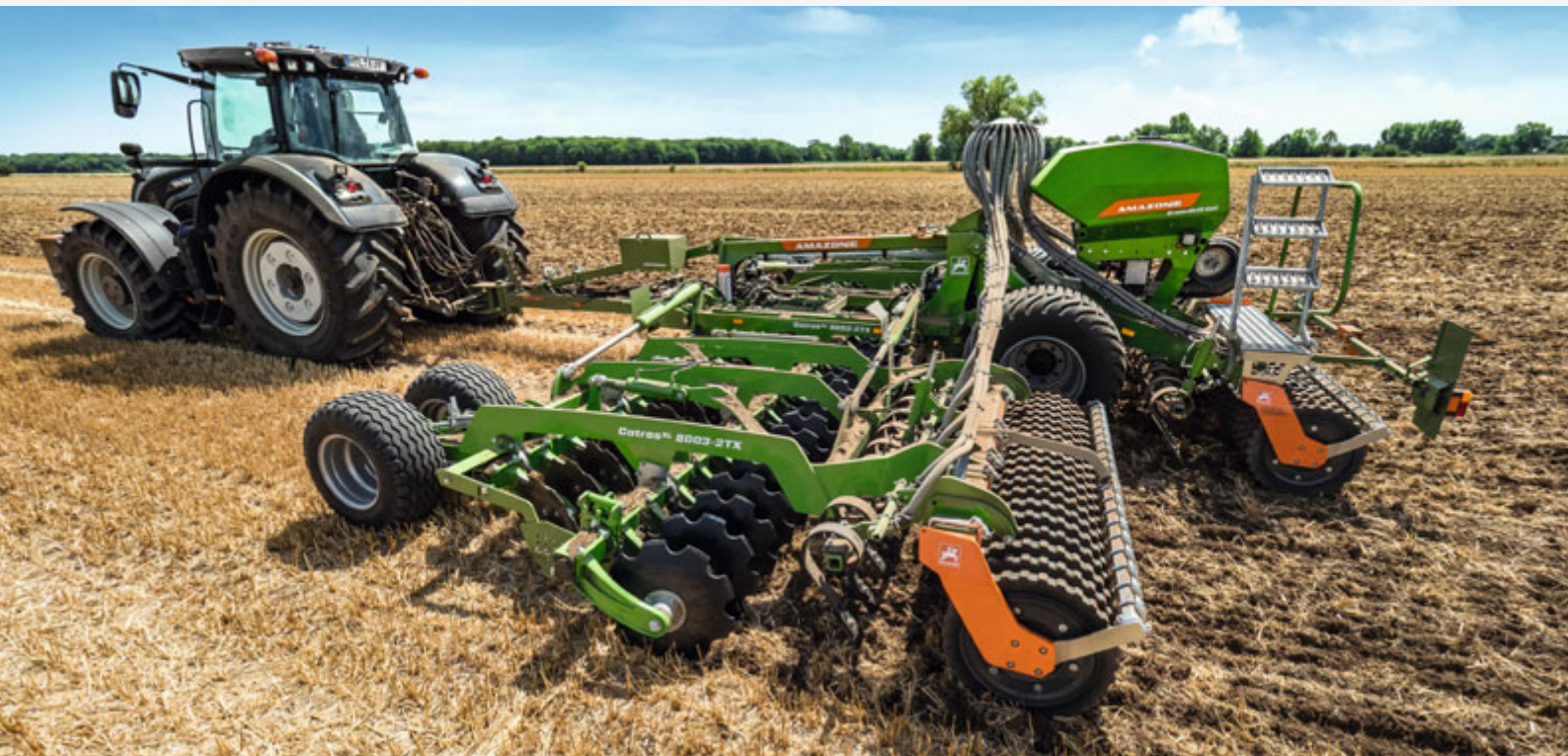
Catros XL 8003-2TX при лушении стерни с насадной сеялкой для промежуточных культур GreenDrill
