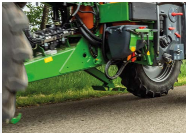
Дышло с нижним зацеплением с гидравлической стояночной опорой
