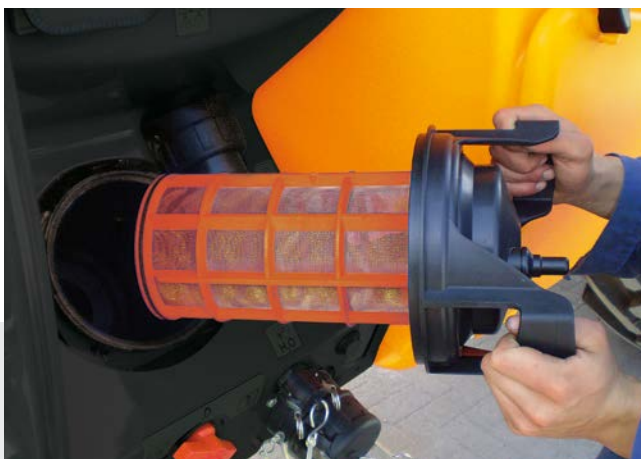
Фильтр грубой очистки можно открыть и очистить при заполненной машине без потерь препарата.
