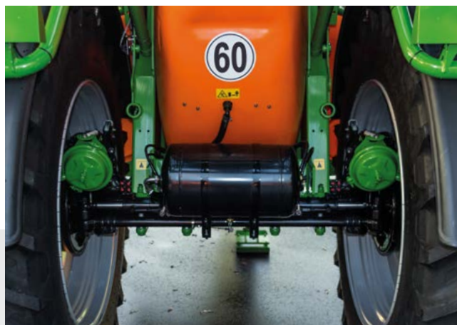
Руление с поворотными кулаками AutoTrail
