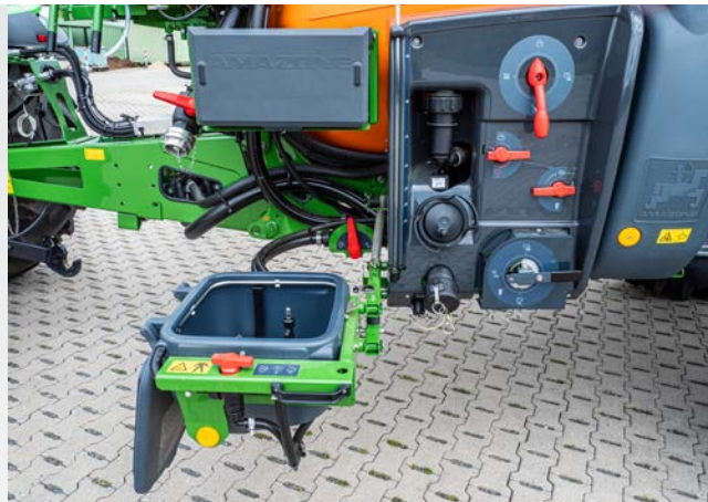
SmartCenter на левой стороне машины с разложенным промывочным баком
