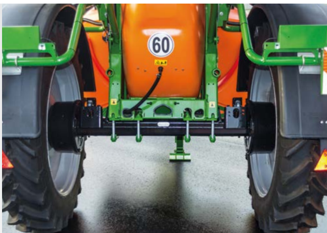
Неподвижная ось с шириной колеи от 1,50 м до 2,25 м
