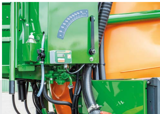
UX 5200 Special с Comfort-пакетом и цифровым указателем уровня
