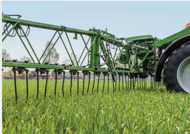
Оснащение шлангами для внесения удобрений с AmaSwitch 4-корпусным и комплектом для смещения на штанге Super-L2
