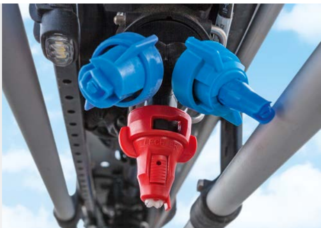
✔ Электрическое пофорсуночное включение AmaSwitch
