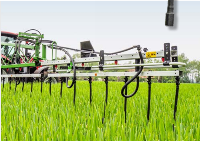
Шланги для внесения удобрений на штанге Super-S2
