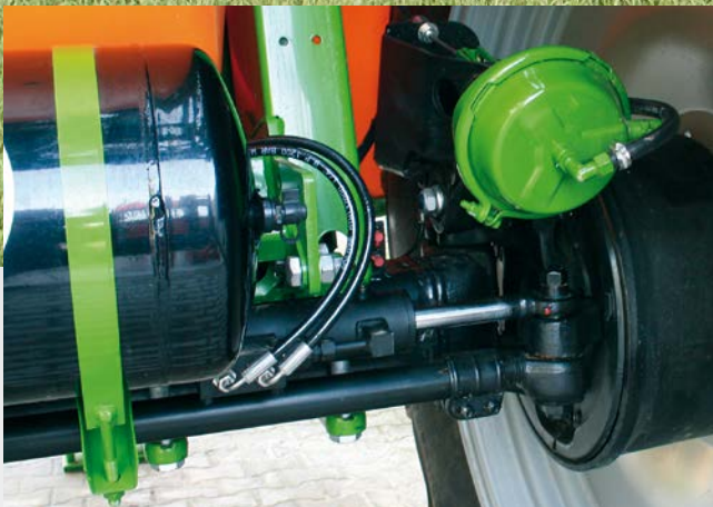
✓ Руление с поворотными кулаками AutoTrail
