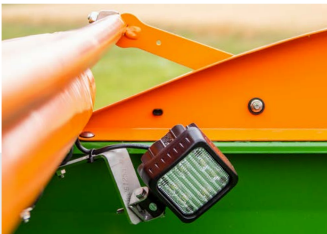
Внутреннее освещение бункера
