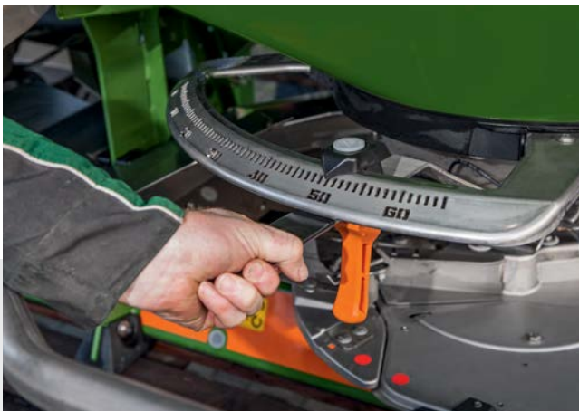
✔ Механическая регулировка распределяющей системы
