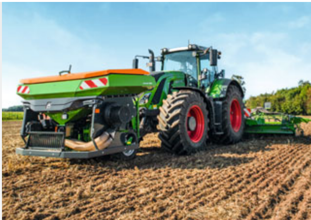
Фронтальный бункер FTender 1600 с объемом 1.600 л
