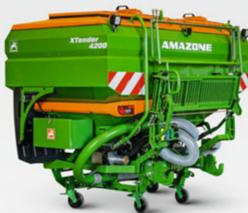
Навесной бункер XTender 4200 с объемом 4.200 л
