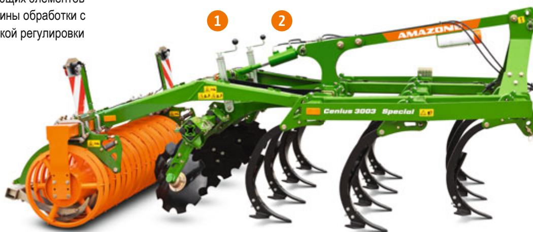
Cenius Special: Стойки C-Mix с предохранительным механизмом в виде срезного болта и угловым профильным катком
