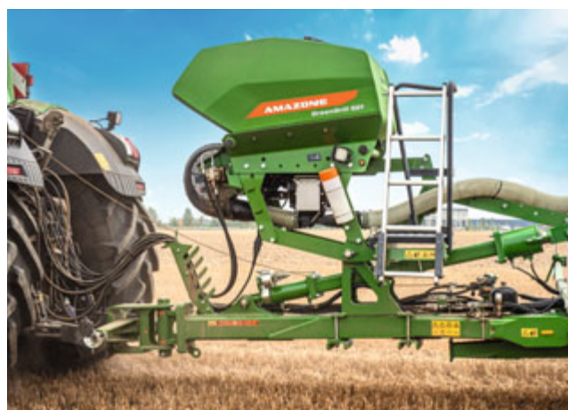
GreenDrill 501: для всех прицепных машин с объёмом бункера 500 л и гидравлической турбиной
