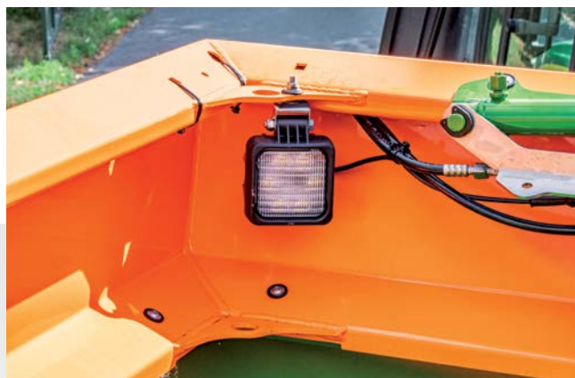
Рабочее освещение внутри бункера
