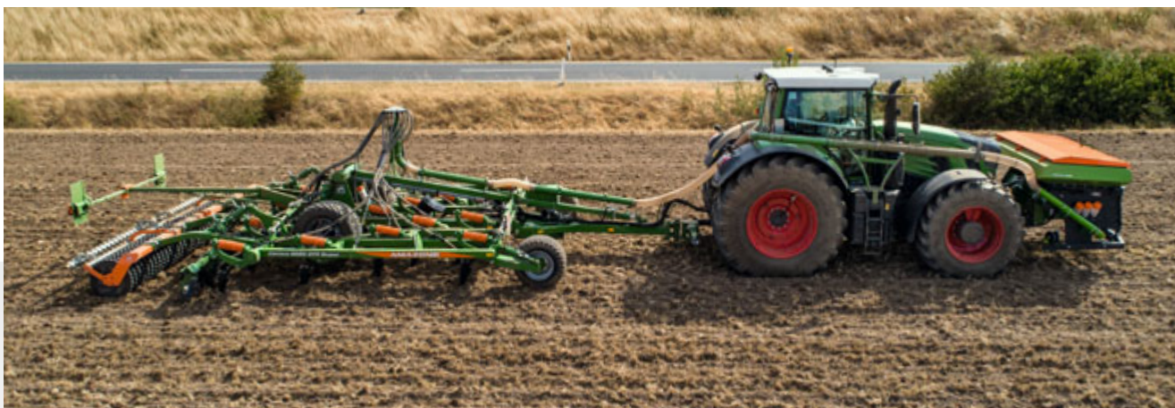
Фронтальный бункер FTender 1600 с прицепным культиватором Cenius-2TX
