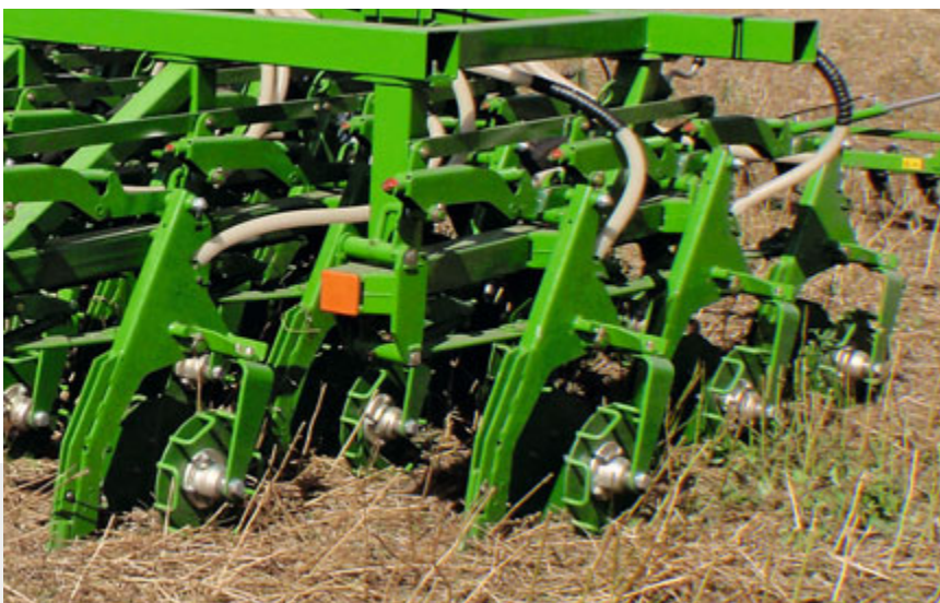
Рамочный каток для мульчированного и прямого посева
