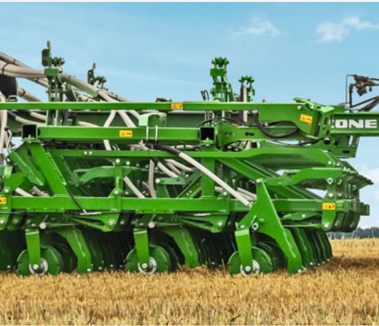
Параллелограммная подвеска долотовидных сошников
