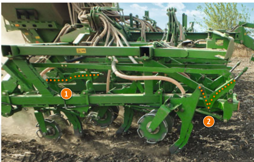
Предохранительный механизм REVOMAT: Верхняя тяга прямая ① долотовидный сошник в рабочем положении Верхняя тяга изогнутая ② долотовидный сошник «расцелен» при столкновении с препятствием в почве
