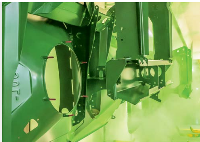
Двойная защита за счет дополнительного нанесения плотного слоя краски методом порошкового напыления повышает защиту от механического воздействия.
