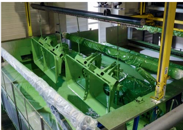
Катодное погружное грунтование всех компонентов обеспечивает практически сплошную защиту от коррозии.
