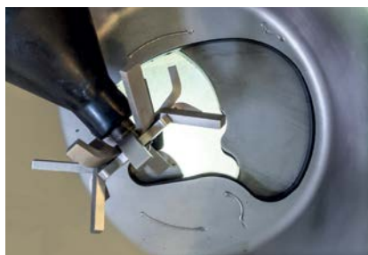
Ступень 2: Отверстие воронки открыто наполовину
