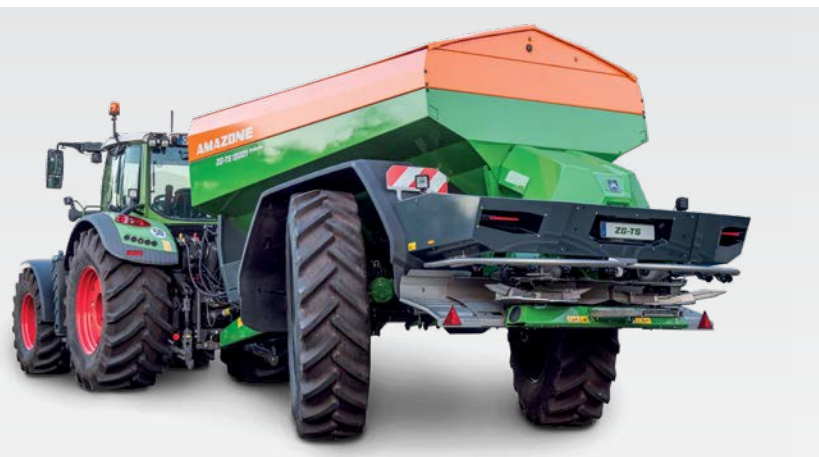
Подруливающая ось с углом поворота до 28°
