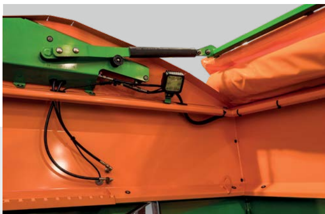
Рабочее освещение внутри бункера
