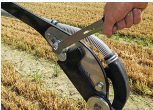
Регулировка долотовидного сошника по глубине
