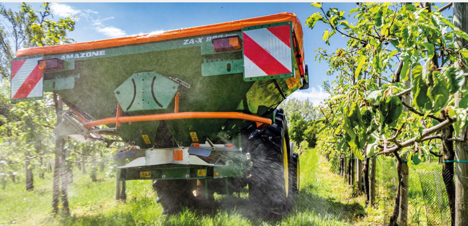
ZA-X 903 Easy с приспособлением для распределения по рядам в плодоводстве
