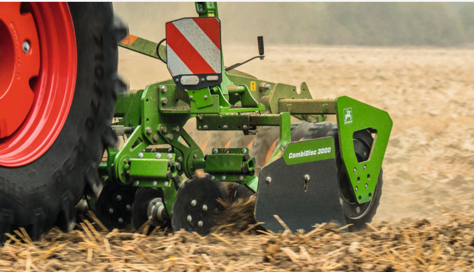
Навесная компактная дисковая борона CombiDisc 3000
