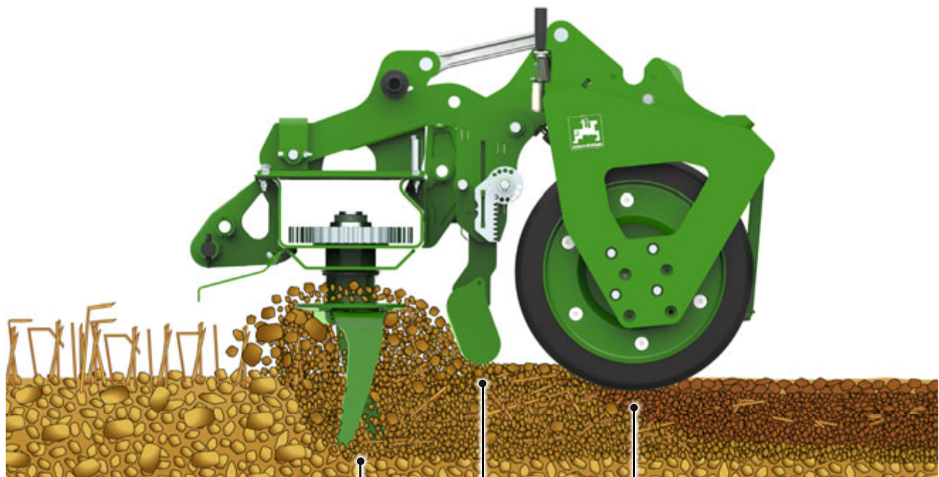
Ротационный культиватор KG с зубьями с агрессивным углом атаки
