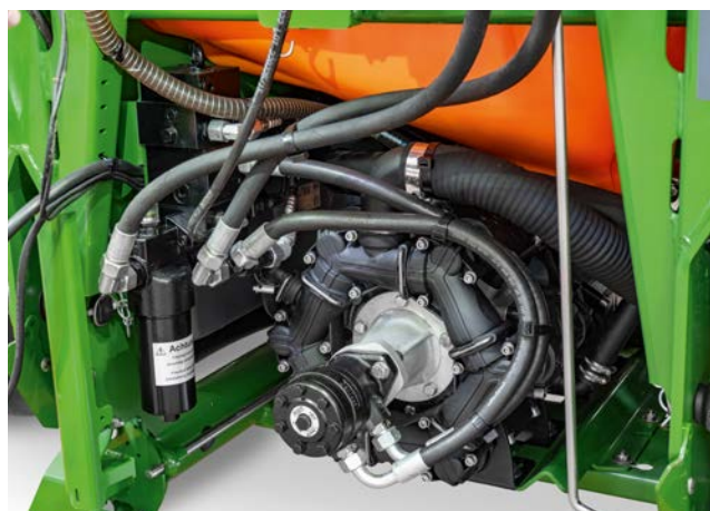
Гидравлический привод насоса 300 л/мин на UF 02
