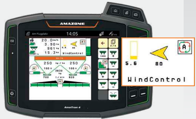
☑ Скорость и направление ветра отображаются на терминале
