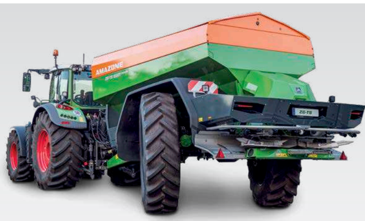
Подруливающая ось с углом поворота до 28°
