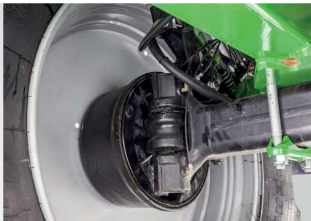
Регулировка тормозного усилия за счет электронной тормозной системы (EBS)
