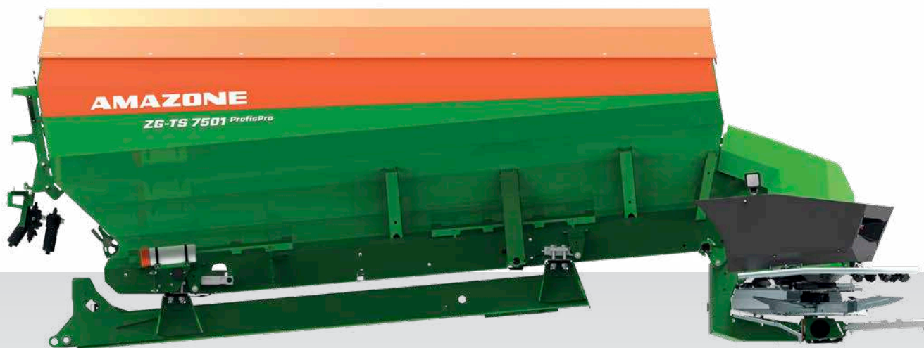
✔ Оптимальное распределение массы за счет смещенного вперед бункера
