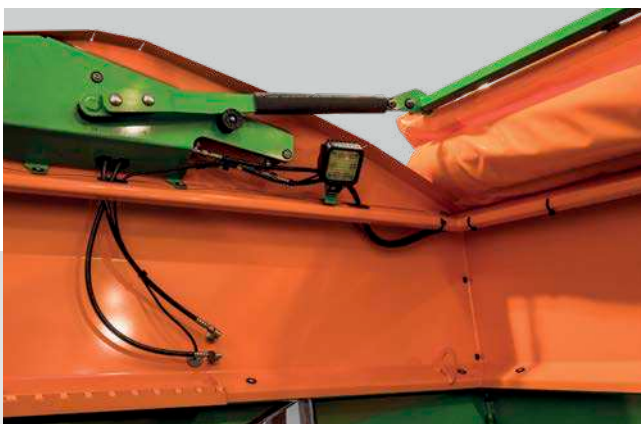
Рабочее освещение внутри бункера
