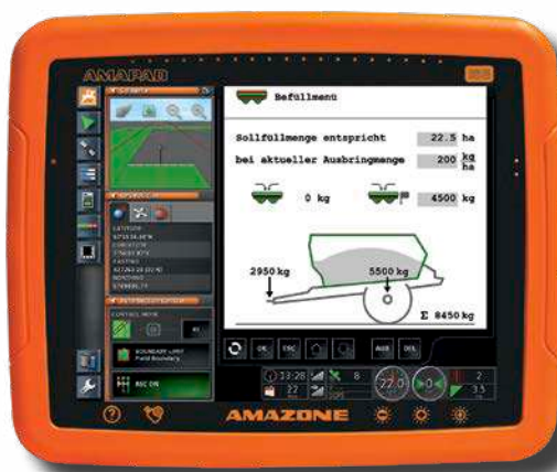
Меню заполнения – Определение требуемого количества материала
