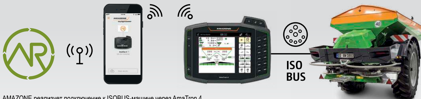
AMAZONE реализует подключение к ISOBUS-машине через AmaTron 4
