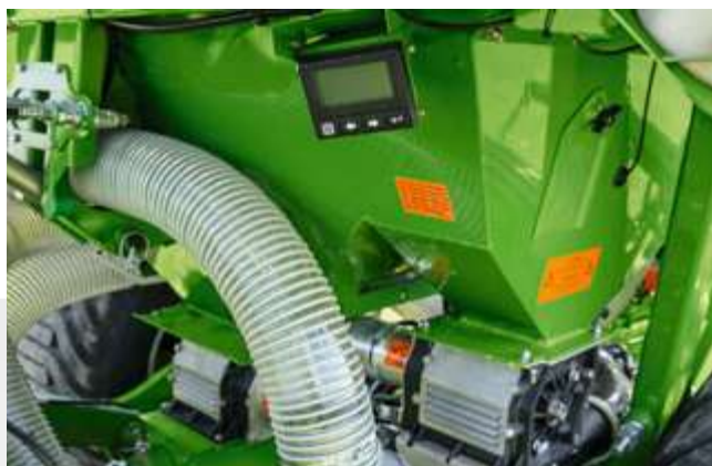
Primera DMC с сервоприводом дозирования и терминалом TwinTerminal 3.0
